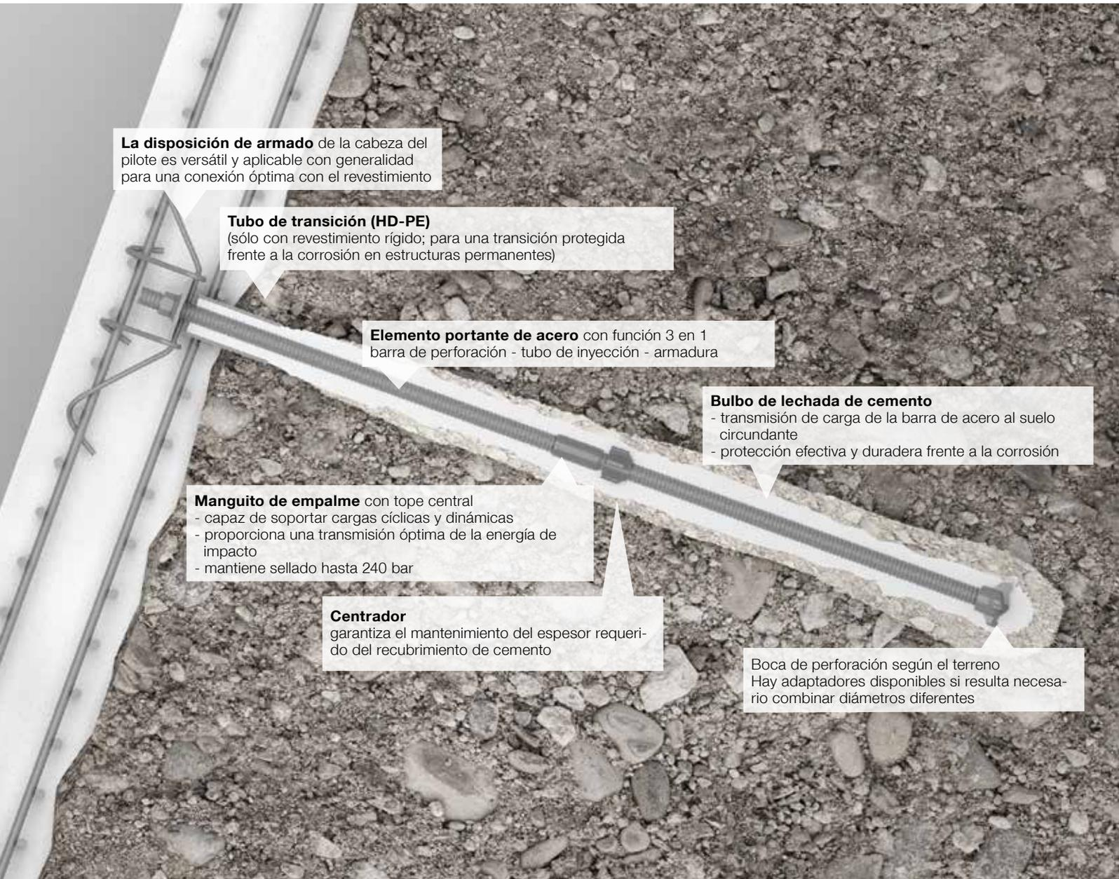
**La disposición de armado** de la cabeza del pilote es versátil y aplicable con generalidad para una conexión óptima con el revestimiento
