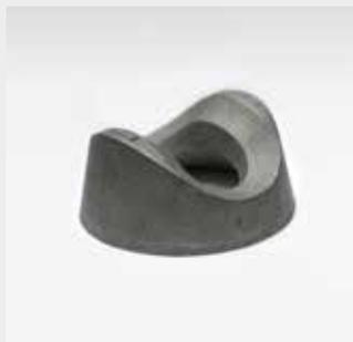
Para diferencias de inclinación entre bulón y talud de hasta  $\pm 36^\circ$  puede usarse el disco de compensación **autocentrado TITAN** (a la derecha con placa de garra).
